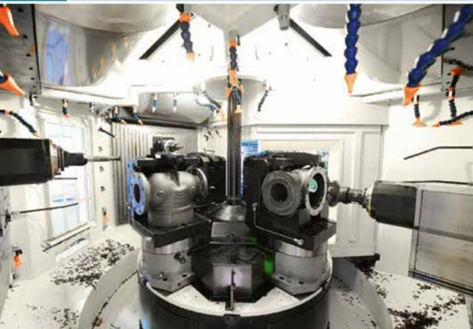
2 Mit drei Spindeln schneller zum fertigen Teil, bei hoher Präzision und weniger Umspännvorgängen (© Porta Solutions)
